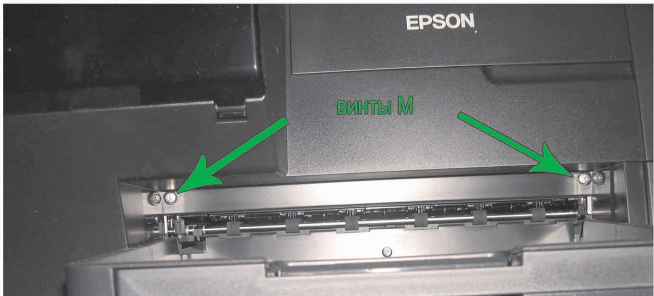
3. отщелкиваем две защелки отверткой и тянем морду “на себя”.
