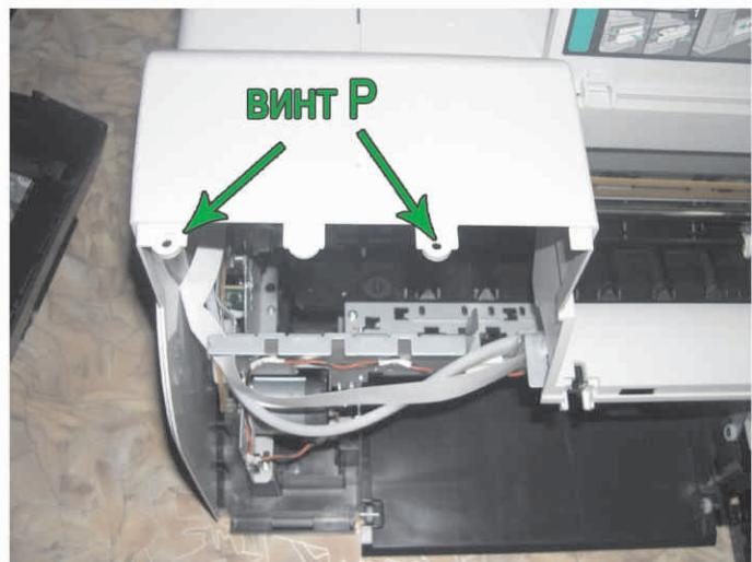
показаную красным крестиком крышку сняли, все указанные винты открутили. тянем белый корпус вверх (осторожно). панель просовываем в дырку (рис. --> и ложим на железный кожух системной платы.
