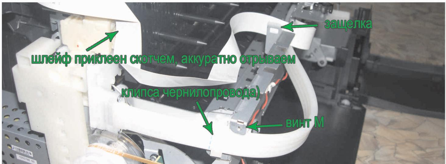
откручиваем показанные винты, отделяем скотч, отщелкиваем клипсы. после чего аккуратно вынимаем всю конструкцию и приступаем к выкручиванию винтов Р - зеленые стрелки на стр.2. !!! - обратите внимание как должно быть.
