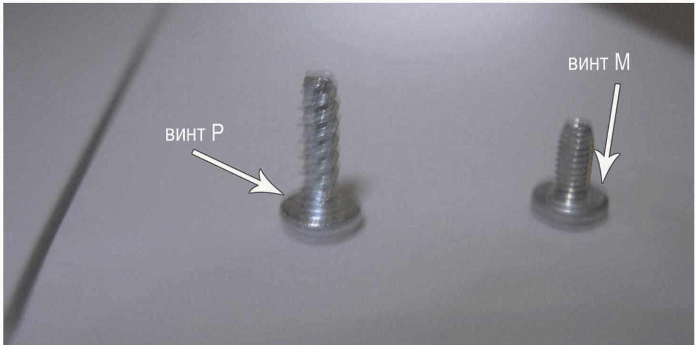
что такое винт Р и винт М: эпсон использует всего два типа винтов,
